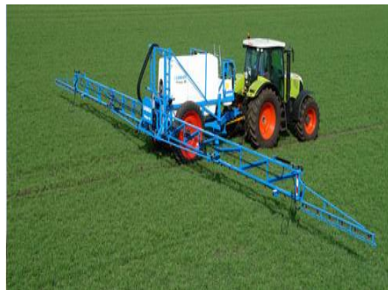
رشاشة حقلية معلقة على جرار وتدار بواسطة عمود ادارته الخلفي
