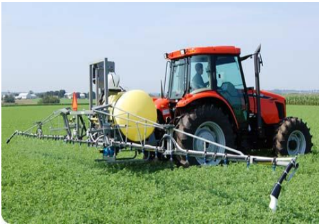
رشاشة حقلية معلقة على جرار وتدار بواسطة عمود ادارته الخلفي
